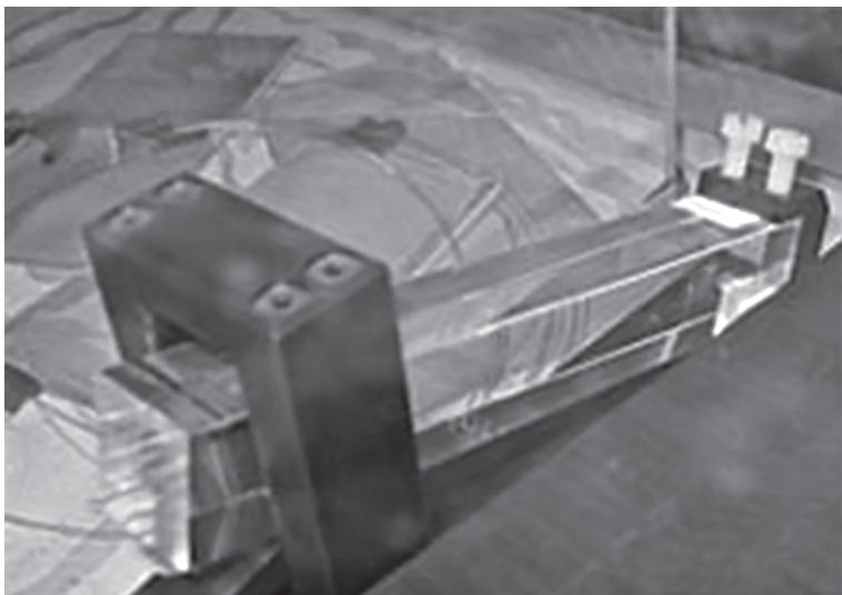
شكل ٨-١٣: صورة فوتوغرافية لبلورة تنجستات الرصاص المستخدمة في المسعر الكهرومغناطيسي باللولب المركب للميونونات.
