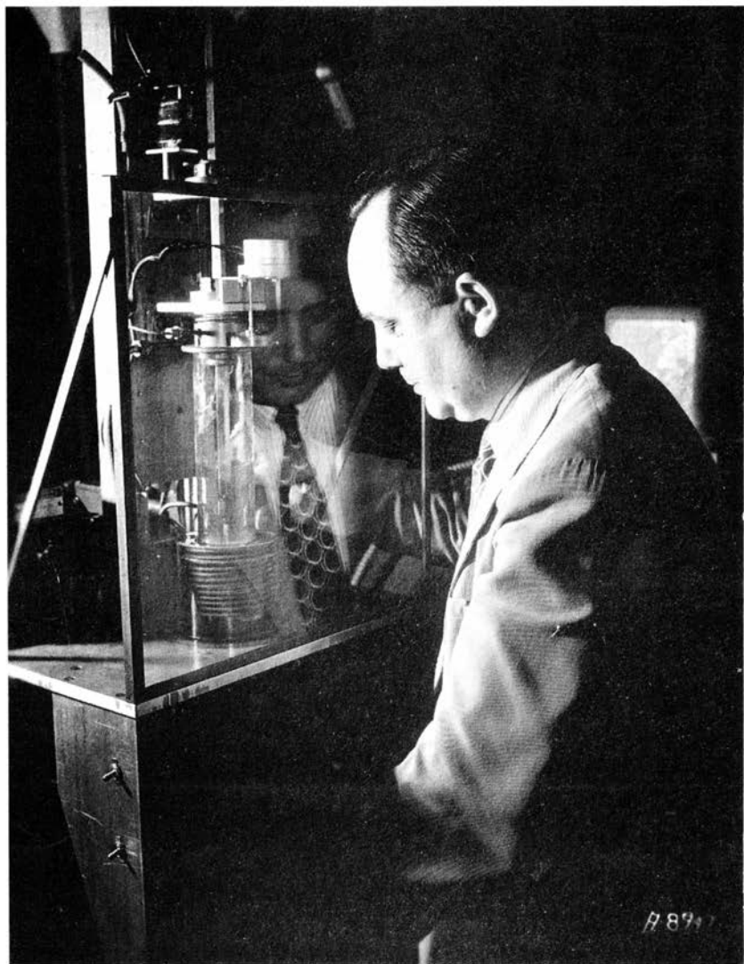
صورة 100: جوردون تيل، كيميائي بمختبرات بيل، يسحب بلورة جرمانيوم نقية من تجمع منصهر صغير.
