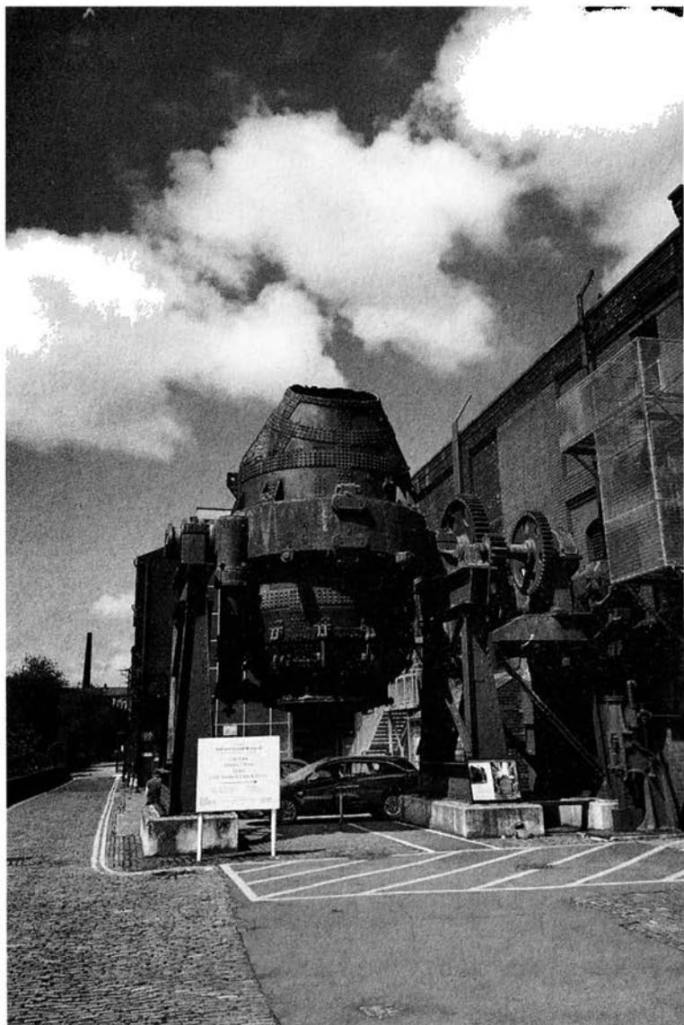
صورة 17: محول بسمر المستخدم لصناعة الصلب بنفخ الهواء.
