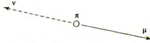
شكل 3.14: تفكك الباي ميزون الساكن إلى ميون ونيترينو لهما كمية حركة متساوية ومتعاكسة. الطاقة الكلية للميون والنيترينو تساوي الطاقة السكونية للباي.
