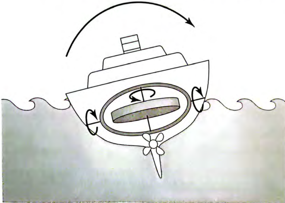
شكل 4.4: جيروسكوب تثبيت السفن: ينشأ من رفع الجيروسكوب للأمام عزم دوران يُدير السفينة نحو اليمين.
