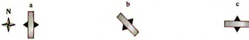
شكل 4.7: تنزع البوصلة الجيروسكوبية المثقلة إلى توجيه محور دورانها ليكون موازيًا لمحور دوران الأرض.
